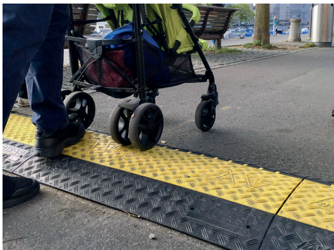
Pont de câble à Zurich
